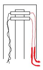
TRACK WIRE SHOWN (IN BLACK) ON LEFT SIDE OF TERMINAL STRIP. BONDSTRAND SHOWN (IN RED) ON RIGHT SIDE OF TERMINAL STRIP. TERMINAL HARDWARE REMOVED FOR CLARITY.
